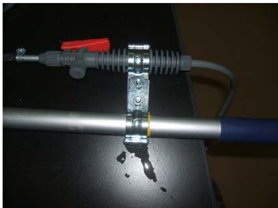
グラスファイバー管とホースをつなぐのにちょっと苦労した。自分の目感覚で材料を買っているので、ちょっとホースが細かった。でもラジオペンチの先端で管を広げて突っ込むとびったりとはまった。そこにクリップを掛け固くねじ留め。これを2カ所。最後に1号の時と同じように、グラスファイバー管の先端をビスで閉鎖し、その近くに小さな穴を2カ所開け、さらにワイパーに穴を開け、ホースバンドでがっちり固定。ちょっと曲がってしまったけど、それは、ご愛嬌。
