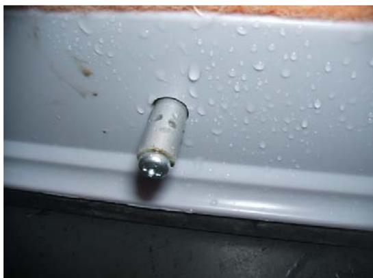
しながら加工した。噴霧器のパイプは、柄の先端にドリルで穴を開けて通した。レバー部分と加工したワイパーの柄の部分は、比較的ぴちっとはまったが、多少ぐらぐらした。そこで、水道のホースを蛇口に連結する時、水漏れを防ぐためのホースバンドでがっちり締め付けた。これで全くがたつくことなく、レバー部分とワイパー部分が一体化された。
